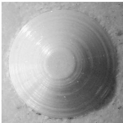
Рис. 7. Копия следа сверления, зафиксированная слепочной массой на стальной пластине
