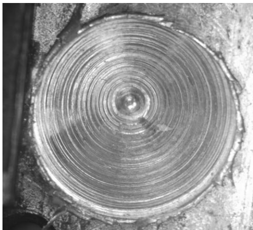
Рис. 1. След сверления на алюминиевой пластине сверлом диаметром 9 мм
