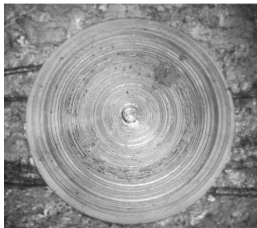
Рис. 2. След сверления на латунной пластине сверлом диаметром 9 мм
