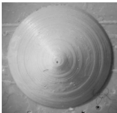
Рис. 6. Копия следа сверления, зафиксированная слепочной массой на латунной пластине
