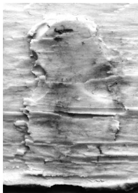
Рис. 8. Копия статического следа орудия взлома, зафиксированная слепочной массой на деревянном бруске
