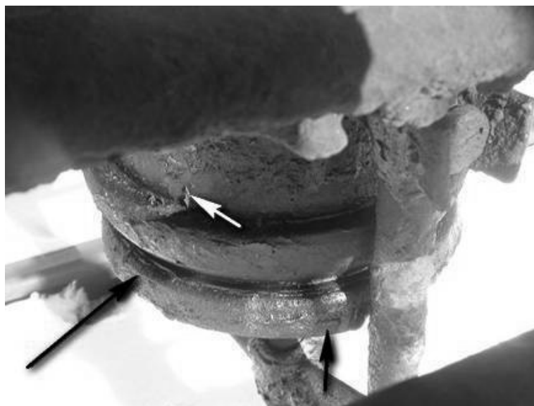
Рис. 6. Следы подсоединения специального сливного оборудования к сливному прибору клапана цистерны
