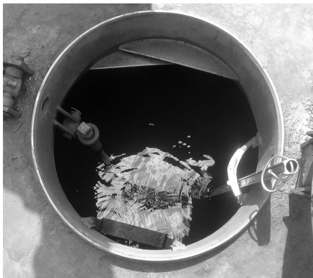
Рис. 2. Фиксация уровня ГСМ в цистерне (справа метршток)
