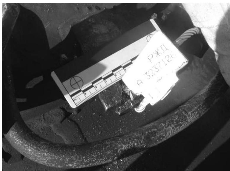
Рис. 1. Пропил пломбировочного ушка на крышке загрузочного люка цистерны
