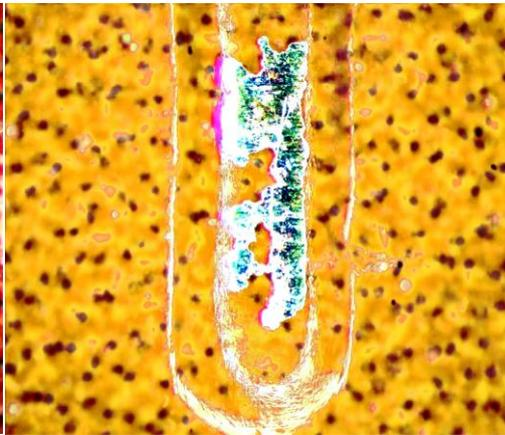
Рис. 4. Фрагмент рельефного знака на поперечной пластиковой карте, выполненный путем типирования
