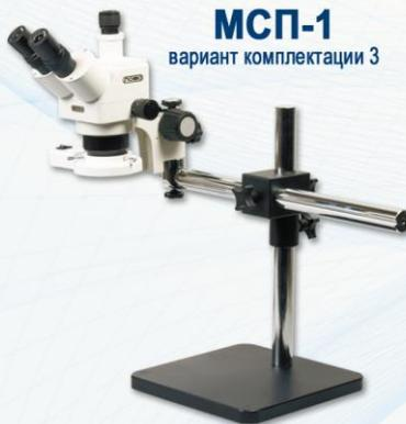
Штатив обеспечивает возможность перемещения оптической головки в горизонтальном (до 320 мм) и вертикальном (до 300 мм) направлениях, изменять угол наклона головки (до 45°).
