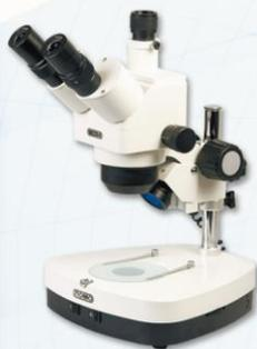
Возможность освещения проходящим или падающим светом, обеспечивает исследование прозрачных, полупрозрачных и непрозрачных объектов.
