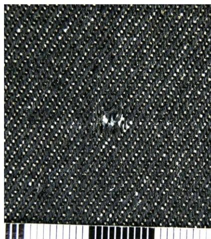
*Рис. 10.* Огнестрельное повреждение на мишени из джинсовой ткани, образованное при стрельбе из АК-74М с дистанции 20 см
