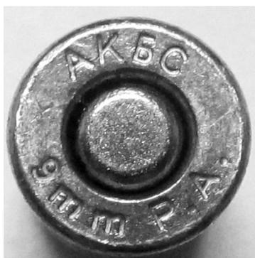
Рис. 4. Заводская маркировка патрона травматического действия
