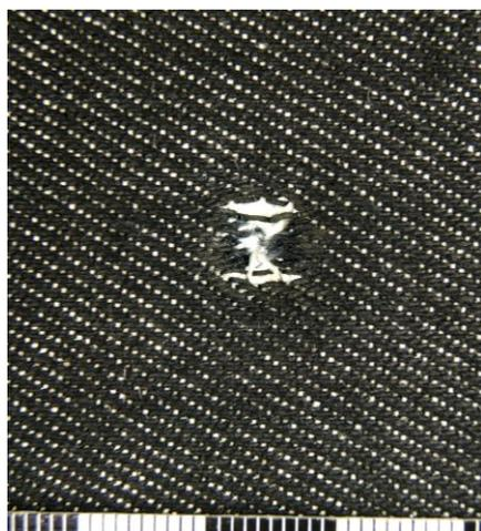
*Рис. 9.* Огнестрельное повреждение на мишени из джинсовой ткани, образованное при стрельбе из ПМ с дистанции 20 см
