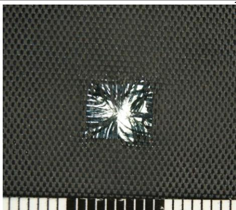
*Рис. 1.* Огнестрельное повреждение на мишени из плащевой ткани, образованное при стрельбе из ПМ с дистанции 30 см
