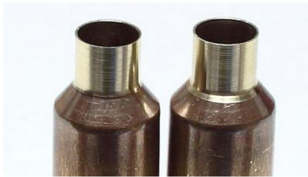
Рис. 31. Обточенные дульца гильз (на гильзе слева дульце обточено без захода на скат, на гильзе справа – с заходом)
