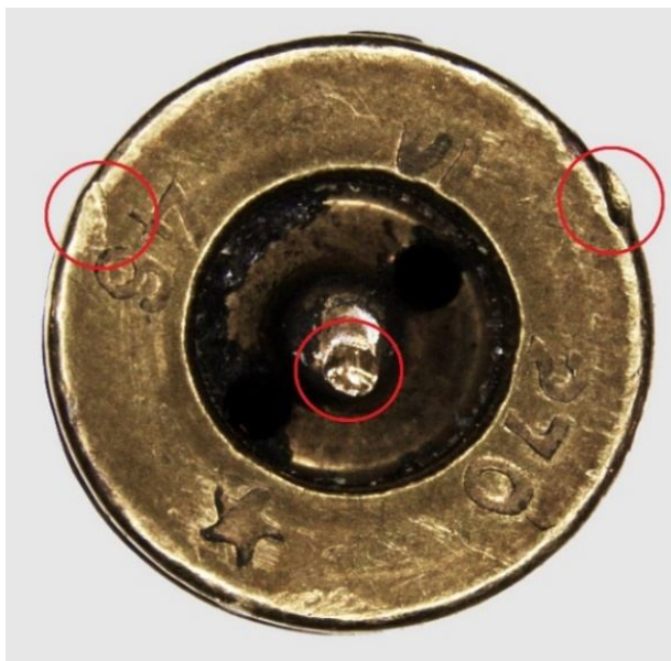
Рис. 1. Следы применения декапсюлятора «бердан» на торце донной части гильзы и наковальне
