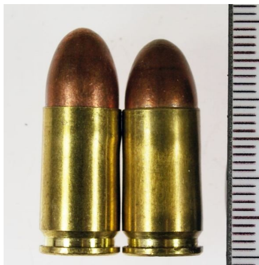
Рис. 32. Патроны 9 × 19 с разной глубиной посадки пуль
