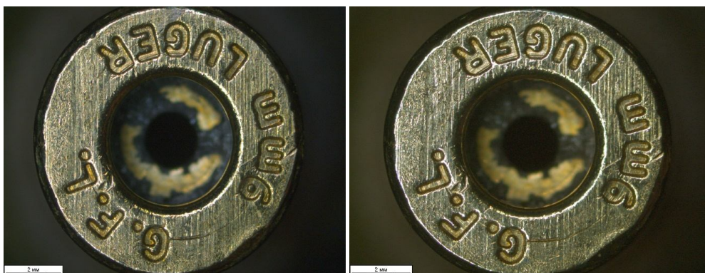
Рис. 4. Следы оружия на торце донной части гильзы до галтовки (слева) и после галтовки (справа)
