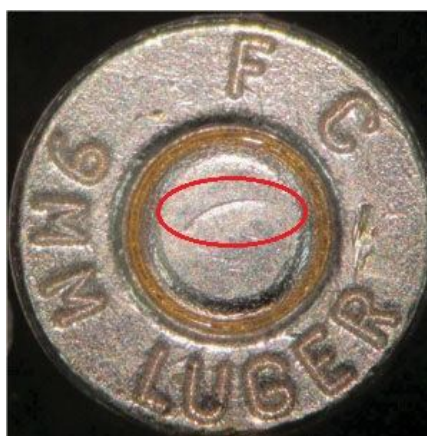
Рис. 8. След штока капсюлятора при перекосе капсюля
