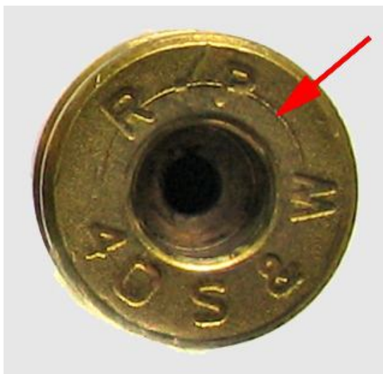
Рис. 5. След от зажима электроинструмента на торце донной части гильзы
