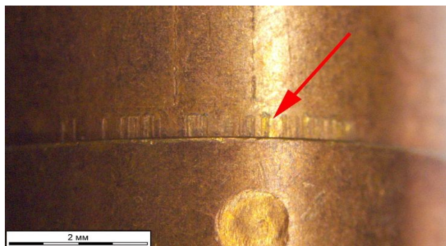
Рис. 30. Следы от внутренней кромки среза гильзы
