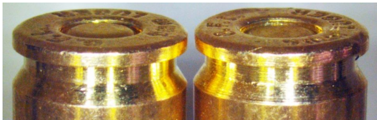
Рис. 10. Различная глубина посадки капсюлей в капсюльные гнезда
