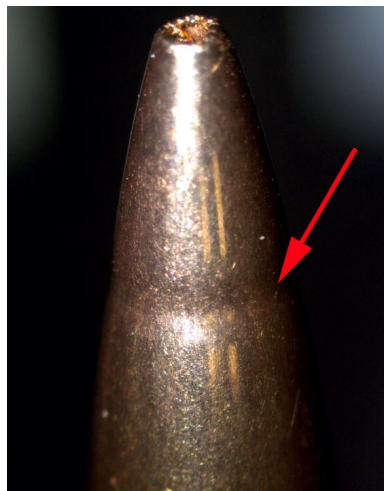
Рис. 23. След посадочного конуса на головной части пули
