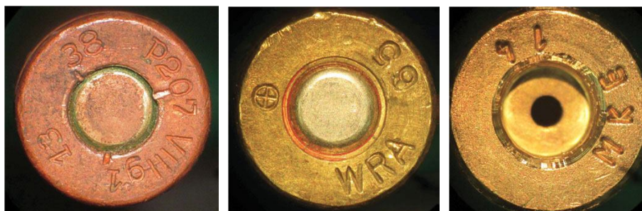
Рис. 7. Трехточечное (слева) и круговое (в центре) крепление капсюля; справа – следы удаления кримпа фрезой
