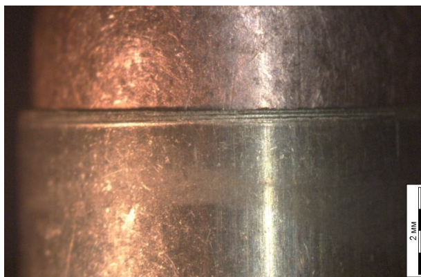
Рис. 25. Следы кримповочного кольца посадочной матрицы на срезе гильзы цилиндрической формы патрона 9 × 18
