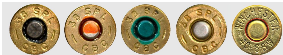
Рис. 16. Герметизирующее покрытие капсюля на самостоятельно снаряженных патронах (на первой справа гильзе имеются остатки старого покрытия, на второй справа оно полностью отсутствует)
