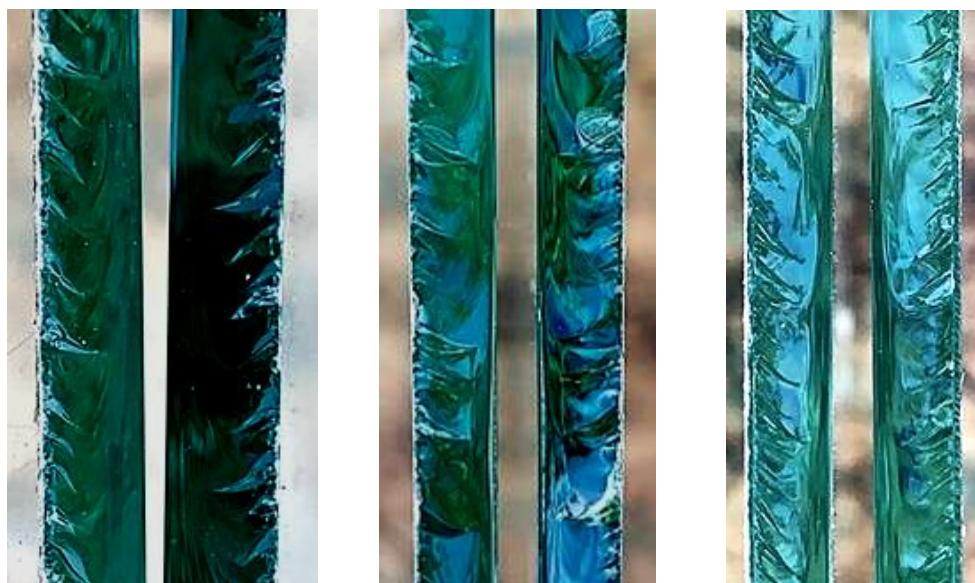
Рис. 11. «Рисунки» на гранях разлома оконного стекла, выполненные алмазным стеклорезом (слева), роликовым стеклорезом без сменного ролика (в центре), роликовым стеклорезом с барабаном, имеющим сменные ролики (справа)
