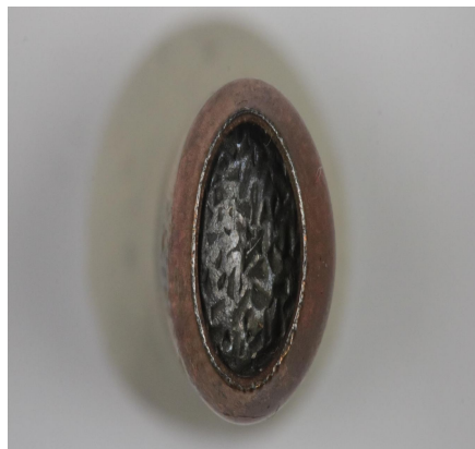
Рис. 3. Деформация ведущей части пули
