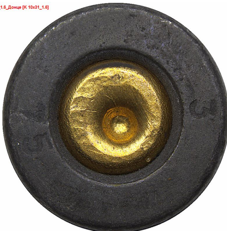
Рис. 2. Торце донной части гильзы патрона 10 × 31 ТТ-СХ со следами частей и деталей светозвукового пистолета ТТ-СХ
