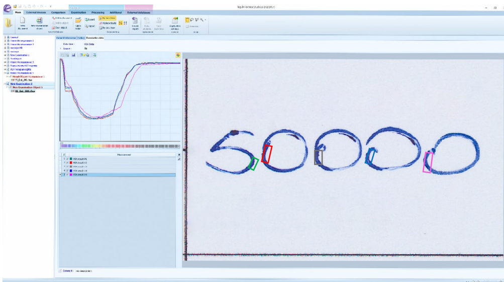
Рис. 1. Результаты гиперспектрального исследования рукописной записи «50 000», проведенного с использованием видеоспектрального компаратора «Регула 4308» и программного обеспечения Regula Forensic Studio 1
