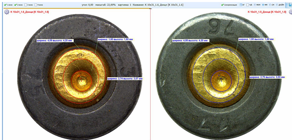
Рис. 4. Сопоставление между собой следов пистолета ТТ-СХ на капсюлях гильз патронов 10 × 31 ТТ-СХ
