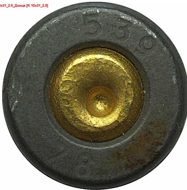
Рис. 3. Торцы донной части гильзы патрона 10 × 31 ППШ-СХ со следами частей и деталей светозвукового пистолета ТТ-СХ
