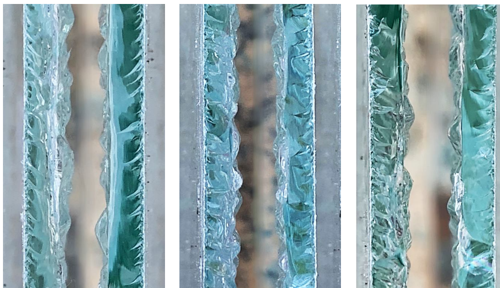
Рис. 12. «Рисунки» на гранях разлома узорчатого стекла, выполненные алмазным стеклорезом (слева), роликовым стеклорезом без сменного ролика (в центре), роликовым стеклорезом с барабаном, имеющим сменные ролики (справа)
