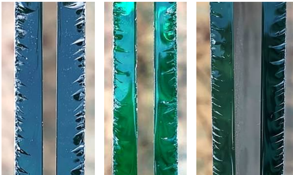
Рис. 10. «Рисунки» на гранях разлома зеркального тонированного стекла, выполненные алмазным стеклорезом (слева), роликовым стеклорезом без сменного ролика (в центре), роликовым стеклорезом с барабаном, имеющим сменные ролики (справа)
