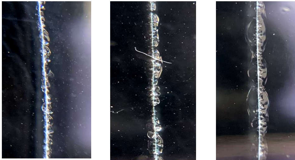
Рис. 7. Линии реза на зеркальном тонированном стекле, выполненные алмазным стеклорезом (слева), роликовым стеклорезом без сменного ролика (в центре), роликовым стеклорезом с барабаном, имеющим сменные ролики (справа)
