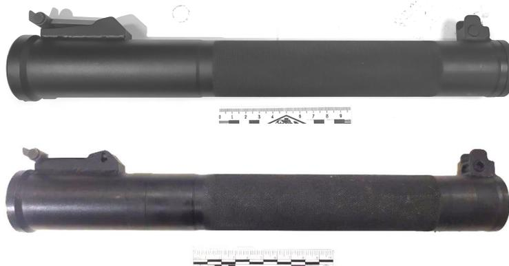
Рис. 4. Корпус кожуха (имитатора глушителя) СОК «МА-Винторез-7,62» (сверху), глушителя ВСС «Винторез» (снизу)
