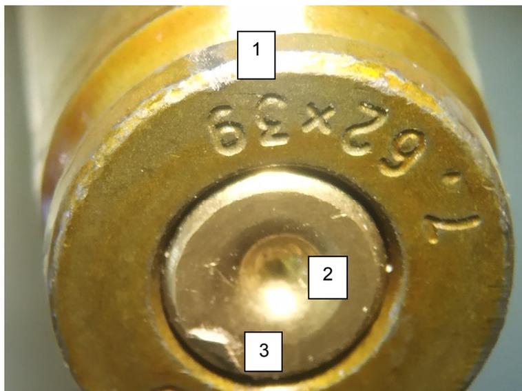
Рис. 8. Следы на донной части гильзы, стрелянной в СОК «МА-Винторез-7,62»
