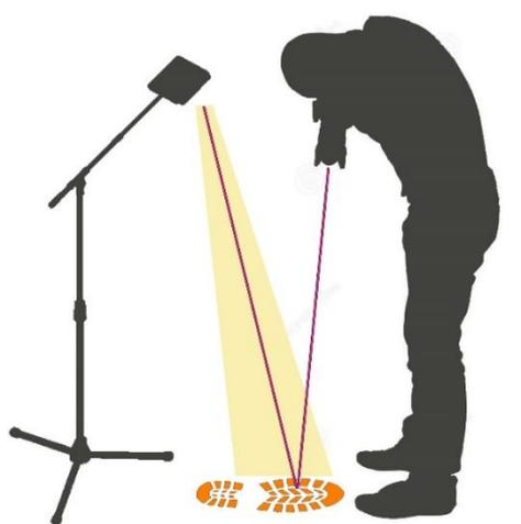
Рис. 12. Фотографический прием съемки следа «в блике»
