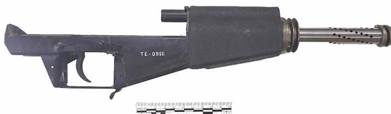
Рис. 3. Ствол со ствольной коробкой, газовой камерой, цевьем ВСС «Винторез»
