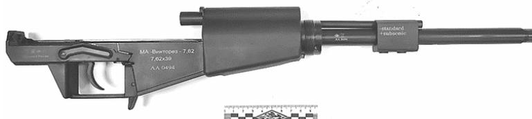
Рис. 2. Ствол со ствольной коробкой, газовой камерой, газовым регулятором, цевьем СОК «МА-Винторез-7,62»
