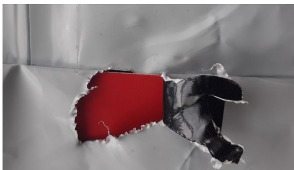
Рис. 6. Разрыв пленочного материала после достижения линии шва
