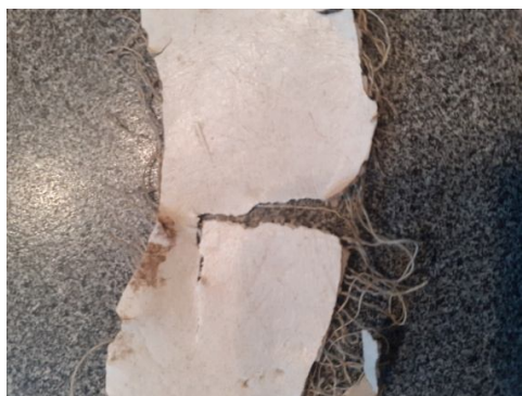
Рис. 8. Разрыв искусственной кожи по направлению приложения усилия между нитями утка и основы тканого слоя. Разрыв проводился руками от края материала, направление приложения усилия близкое к 45^\circ между нитями утка и основы
