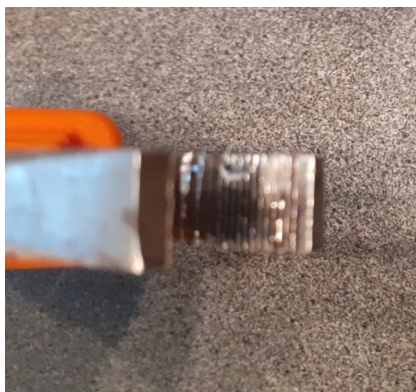
Рис. 11. Следы рабочих поверхностей плоскогубцев (а) на искусственной коже (б)
