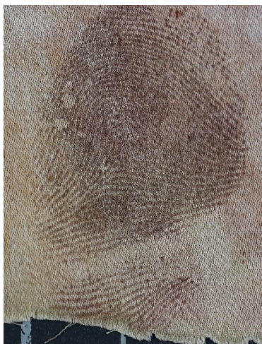
Рис. 1. Потожировой след пальца руки, выявленный раствором азотнокислого серебра на шелке
