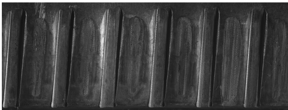
Рис. 2. Следы канала ствола на выстреленной пуле FMJ из карабина «Вепрь-1В» (Парадокс) кал. .366 ТКМ
