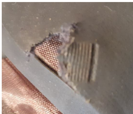
Рис. 11. Следы рабочих поверхностей плоскогубцев (а) на искусственной коже (б)
