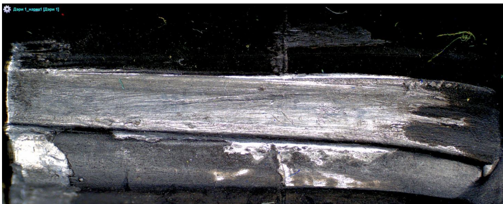
Рис. 4. След поля нарезки на выстреленной пуле «ДЭРИ» из карабина «ВПО-209» (Парадокс) кал. .366 ТКМ (полимерная оболочка сорвана)
