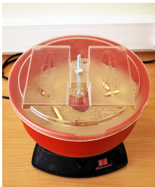
Рис. 2. Галтовочный аппарат для сухой очистки гильз
