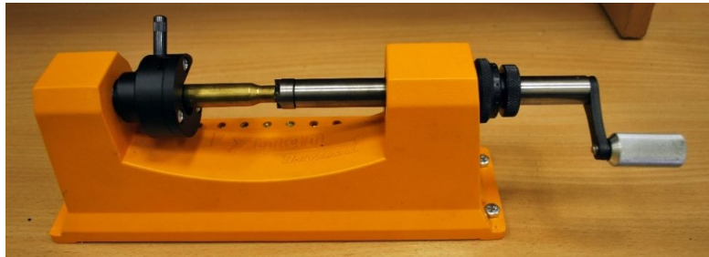
Рис. 11. Настольный триммер для подрезания гильз
