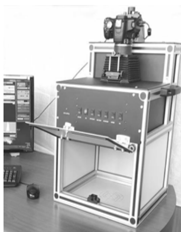
Рис. 1. Многофункциональный осветительный прибор на светодиодных осветителях КПБМ.1161.01
