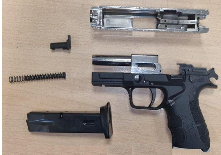
Рис. 6. Неполная разборка пистолета Retay X1 калибра 9 мм Р.А.К.
