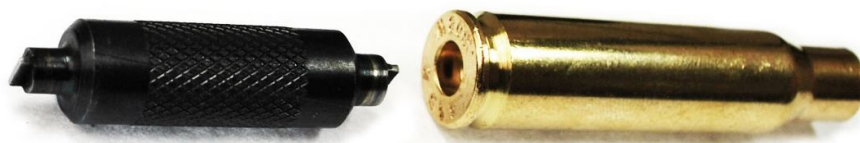
Рис. 3. Фреза для чистки капсюльного гнезда под капсюль «боксер»
