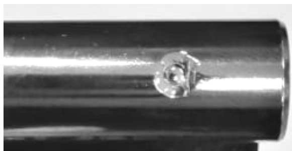
Рис. 8. След на стволе в месте расположения штифта
