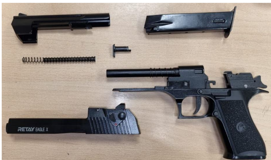
Рис. 2. Неполная разборка пистолета Eagle X калибра 9 мм Р.А.К.
