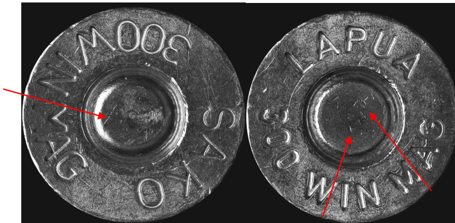
Рис. 1. Следы капсюлятора на поверхности капсюля
