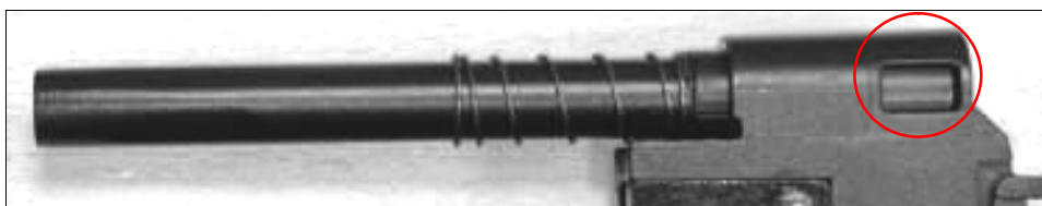
Рис. 4. Ослабление патронника ствола
