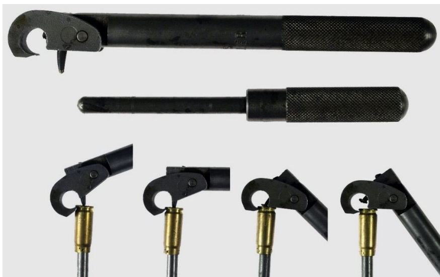
Рис. 1. Декапсюлятор «бердан» и принцип его работы
