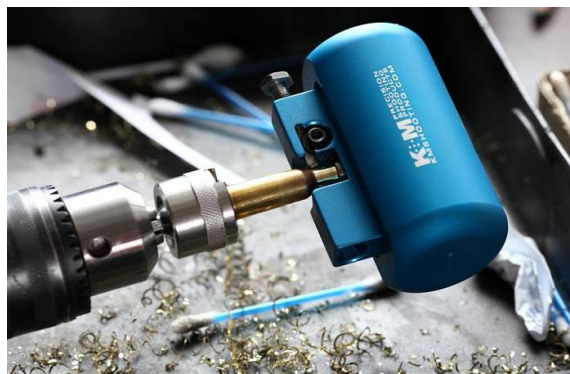
Рис. 13. Точилка для обтачивания дульца гильзы 1
