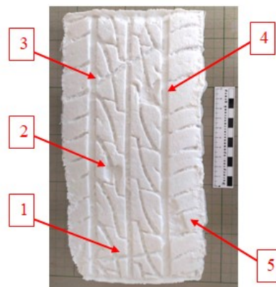
Рис. 13. 3D-модель объемного следа отображения исследуемой шины, изготовленная на 3D-принтере
