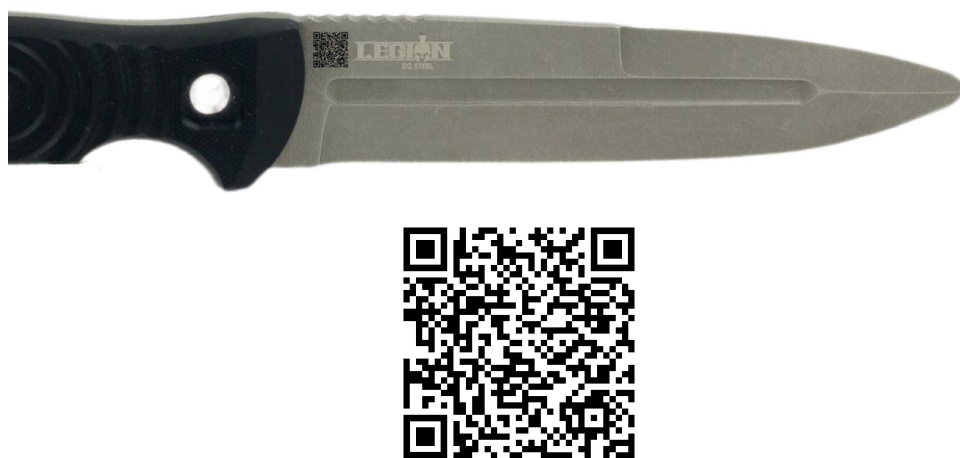
Рис. 4. Сгенерированный матричный код, нанесенный на клинок и содержащий информацию о протоколе испытания туристического ножа Legion D2 TacWash в лаборатории
