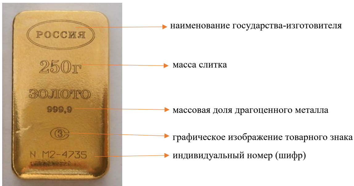
Рис. 3. Внешний вид маркировочных обозначений на слитке
