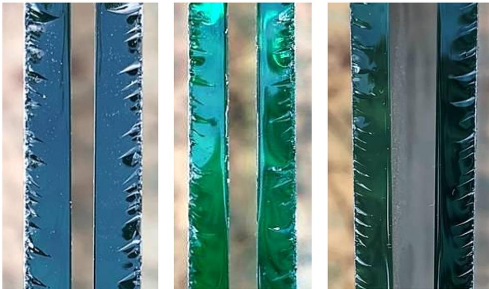
Рис. 10. «Рисунки» на гранях разлома зеркального тонированного стекла, выполненные алмазным стеклорезом (слева), роликовым стеклорезом без сменного ролика (в центре), роликовым стеклорезом с барабаном, имеющим сменные ролики (справа)
