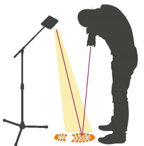
Рис. 12. Фотографический прием съемки следа «в блике»
