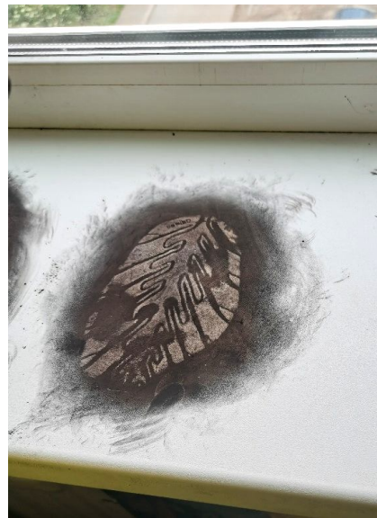
Рис. 9. След обуви, образованный бесцветной фракцией крови, на матовом пластике: а – до обработки; б – выявленный черным магнитным дактилоскопическим порошком
