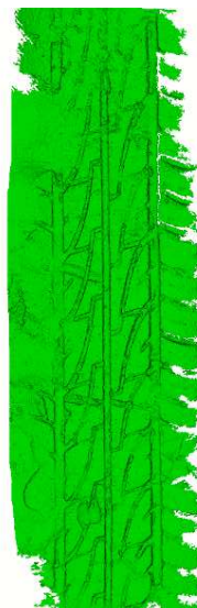
Рис. 12. Полигональная 3D-модель объемного следа протектора шины
