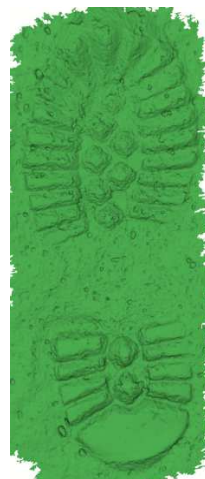
Рис. 6. Полигональная 3D-модель объемного следа подошвы обуви
