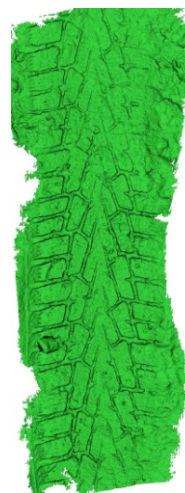
Рис. 8. Полигональная 3D-модель объемного следа протектора шины
