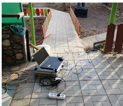
Рис. 3. Подключение 3D-сканера к сети 220 В частного домовладения при помощи удлинителя 50 м
