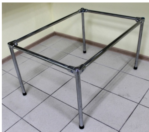
Рис. 1. Каркас затемняющего устройства для 3D-сканирования, изготовленного из системы труб «Джокер»
