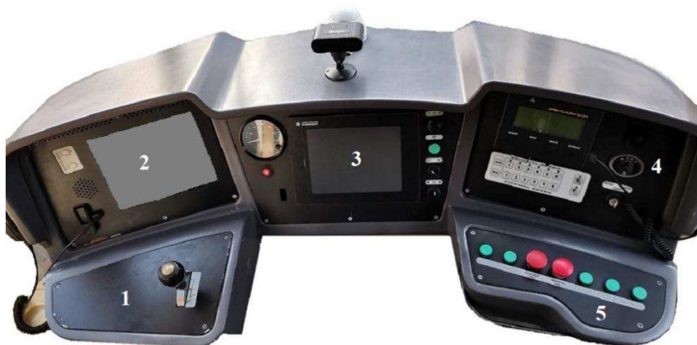
Рис. 4. Пульт управления водителя трамвая модели «Витязь»: 1 – контроллер водителя; 2 – локальный коммутатор визуализации; 3 – панель визуализации информации; 4 – панель клавиатуры дверных приводов; 5 – панель переключателей [8, с. 69]
