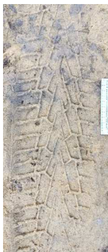
Рис. 7. Объемный след протектора шины, образованный на песке
