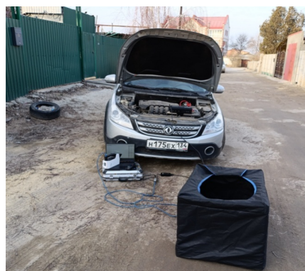
Рис. 4. Подключение 3D-сканера к транспортному средству при помощи автоинвертора Dехр CAR 1500 W
