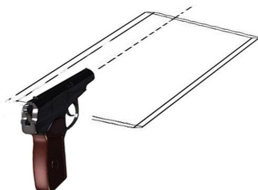
Рис. 1. Схема взаимного расположения оружия и мишени в эксперименте
