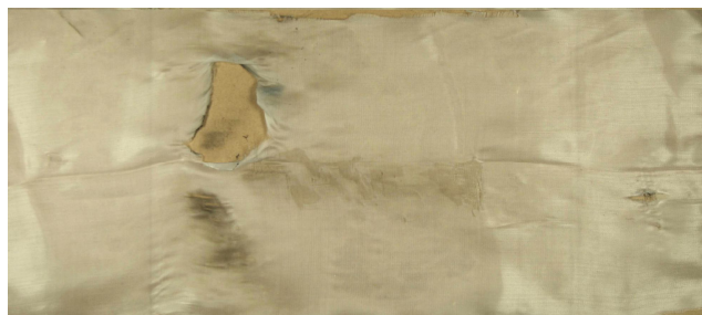
Рис. 4. Повреждения на мишени из органзы, образованные действием пороховых газов, истекаемых из боковых окон дульного тормоза-компенсатора 5,45-мм автомата АК-74М
