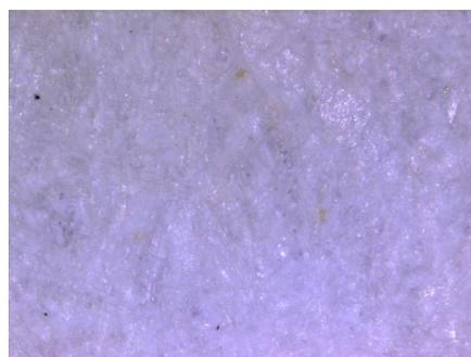
*Рис. 8.* Увеличенное изображение фрагмента бумаги, подверженной «бесконтактному высокотемпературному воздействию» в течение 2 минут
