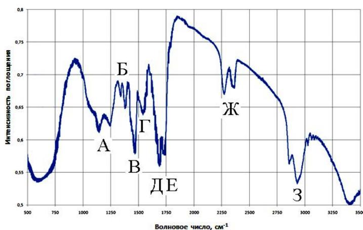
Рис. 1. ИК-спектр нативного образца акриловой эмали Vgulex, Германия
