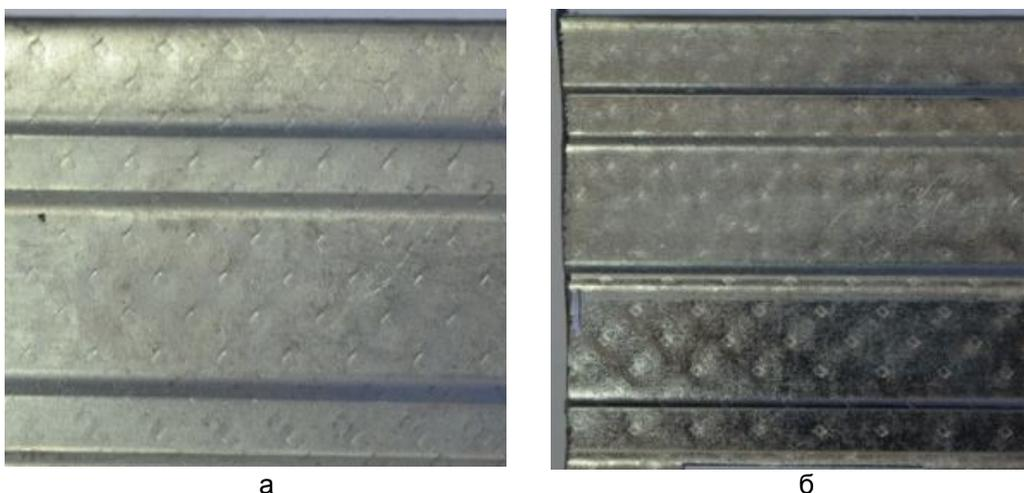
Рис. 2. Образцы исходного профиля: а – стоечного; б – направляющего
