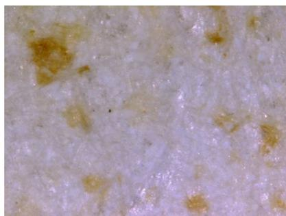
*Рис. 4.* Увеличенное изображение фрагмента бумаги, подверженной «контактному температурному воздействию» в течение 5 минут
