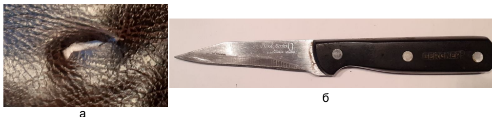
Рис. 6. Колото-резаное повреждение на искусственной коже:
