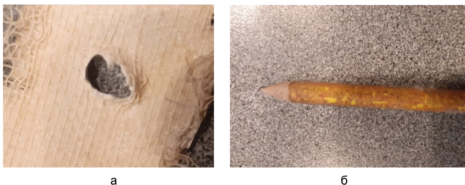
Рис. 3. Прокол на искусственной коже на тканой основе: а – изнаночная сторона; б – орудие повреждения
