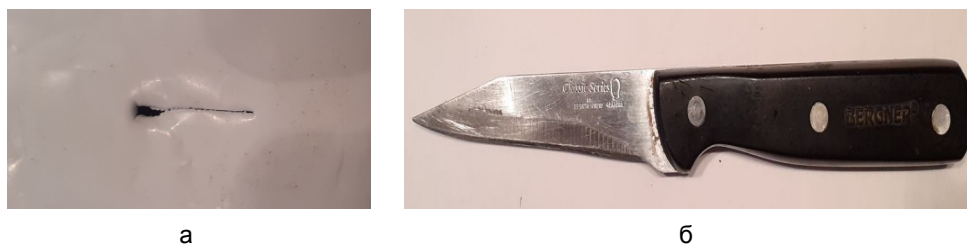
Рис. 5. Колото-резаное повреждение на пленочном материале:
