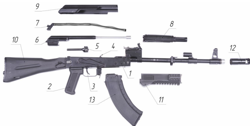
Рис. 2. Детали и сборочные единицы карабина после неполной разборки:
