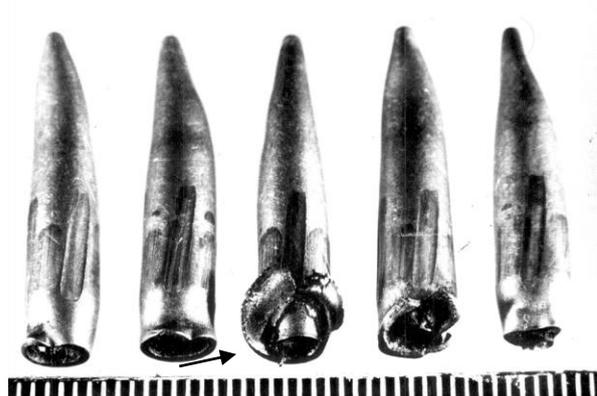
Рис. 12. Сплющивание, надрыв и разворачивание оболочки хвостовых частей пуль, оголение сердечника одной из пуль (отмечено стрелкой) после перфорации ими непрочных многослойных преград
