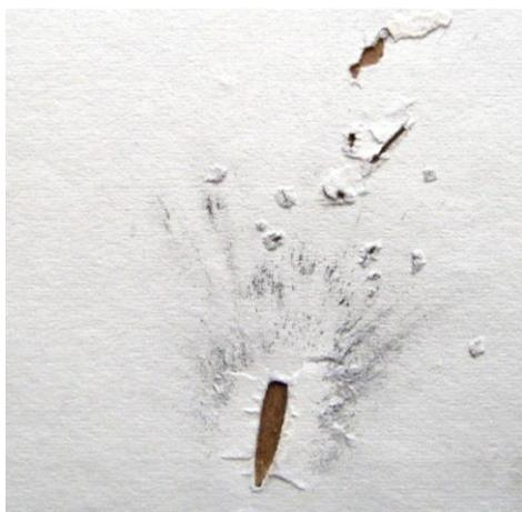
Рис. 9. Обратная сторона листа бумаги с выходным огнестрельным повреждением (четвертая преграда) и следами действия обратного выброса частиц материала преграды
