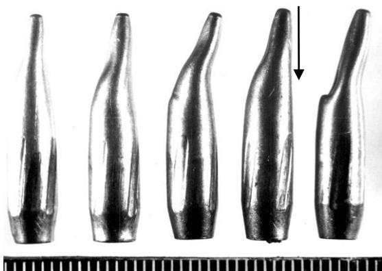
Рис. 11. Изгиб головных частей пуль и надрыв оболочки одной из пуль (отмечено стрелкой) после перфорации ими непрочных многослойных преград
