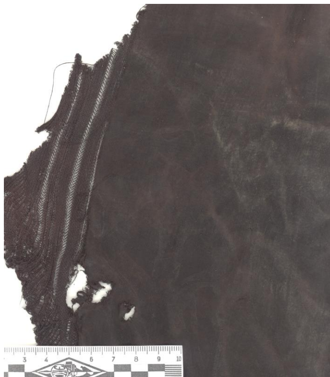
Рис. 4. Лицевая поверхность фрагмента ткани брюк с огнестрельными повреждениями
