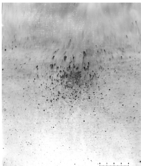
Рис. 5. Точечные и мелкоочаговые отложения металла при стрельбе с дистанции 35 см
