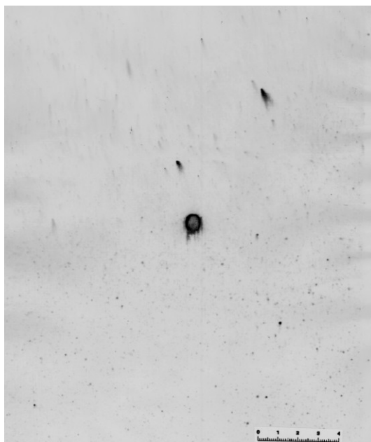
Рис. 7. Точечные и мелкоочаговые отложения металла при стрельбе с дистанции 160 см
