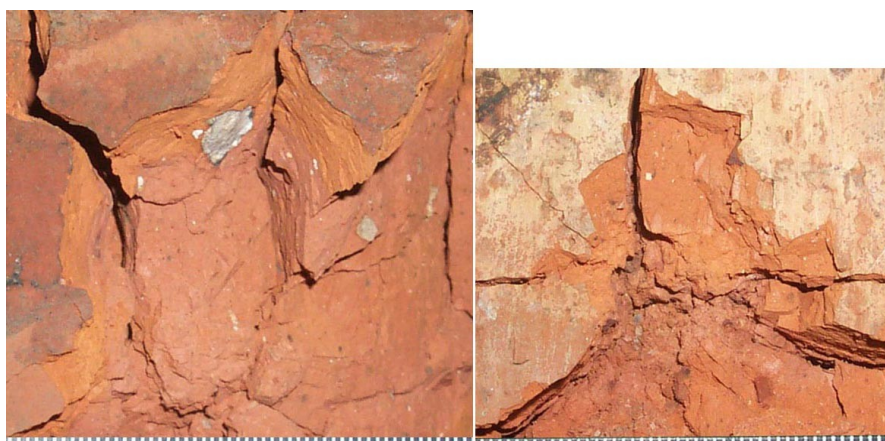
Рис. 6. Следы рикошета пули патрона 57-Н-181С на керамических кирпичях: 1 — УВ 40^\circ , УО 18^\circ ; 2 — УВ 60^\circ , УО 37^\circ
