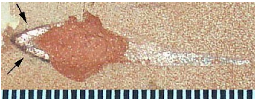
Рис. 9. Отложение частиц копоти и материала пули в точке встречи
