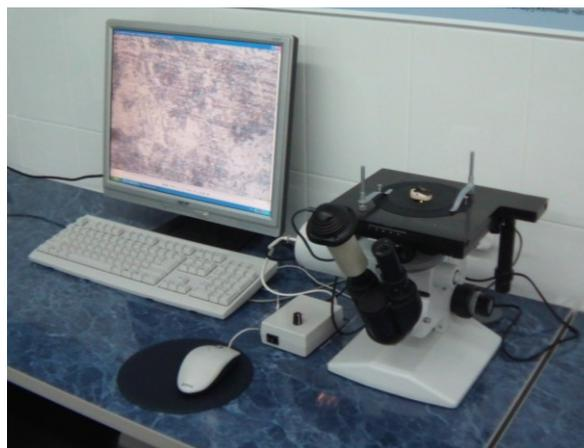
Рис. 2. Рабочее место эксперта для работы на микроскопе EC METAM PB-21, оснащенного цифровой камерой и ПК
