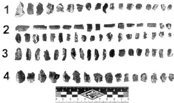
Рис. 11. Осколки оболочки СВУ из стали У-7, снаряженного тетрилом
