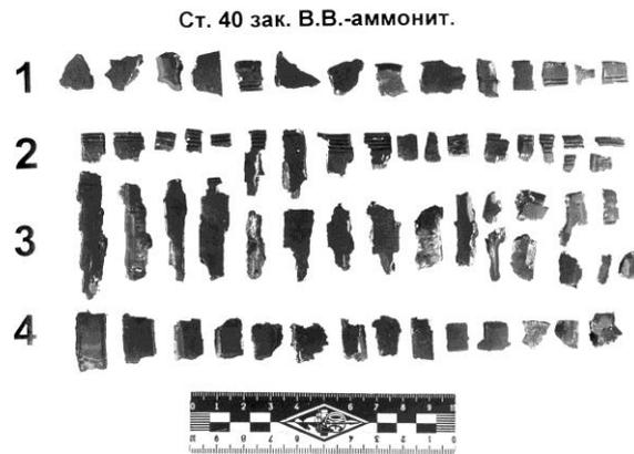
Рис. 7. Осколки оболочки СВУ из закаленной стали 40, снаряженного аммонитом
