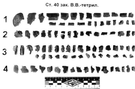
Рис. 8. Осколки оболочки СВУ из закаленной стали 40, снаряженного тетрилом
