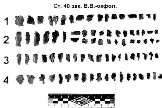
Рис. 9. Осколки оболочки СВУ из закаленной стали 40, снаряженного окфолом
