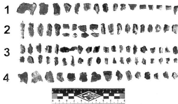
Рис. 12. Осколки оболочки СВУ из стали У-7, снаряженного окфолом
