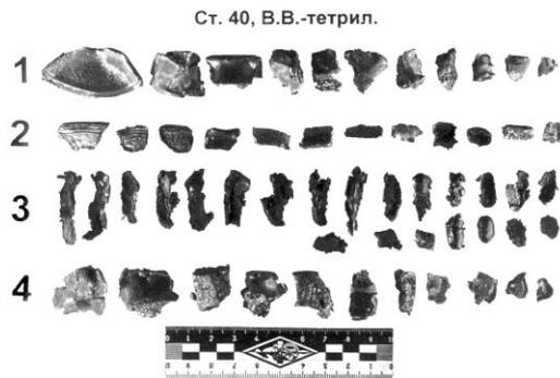
Рис. 5. Осколки оболочки СВУ из стали 40, снаряженного тетрилом
