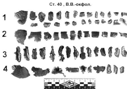
Рис. 6. Осколки оболочки СВУ из стали 40, снаряженного окфолом
