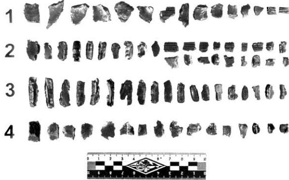
Рис. 10. Осколки оболочки СВУ из стали У-7, снаряженного аммонитом
