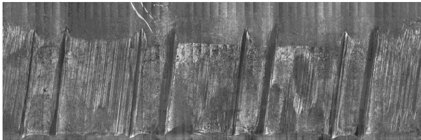
Рис. 3. Фотооптическая развертка поверхности пули, выстреленной из переделанного под патрон 9x18 газового пистолета ИЖ-79. Боевые и холостые грани отобразились в виде глубоких трасс
