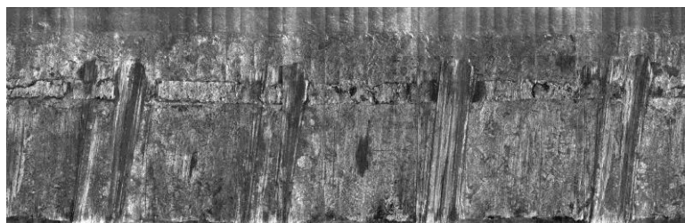
Рис. 1. Фотооптическая развертка поверхности пули, выстреленной из самодельного пистолета, изготовленного под патрон 9x18. Ствол имеет нарезав разной ширины, что соответствующим образом отразилось на ширине следов полей нарезав на пуле (первый слева след поля нарезав шире, чем все остальные)
