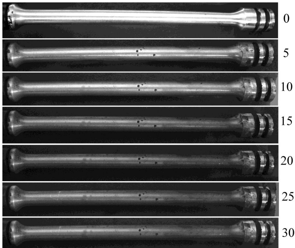
Рис. 3. Газовый поршень АК74 после разного числа выстрелов (ствол, газовая трубка и поршень до выстрелов вычищены и насухо вытерты)
