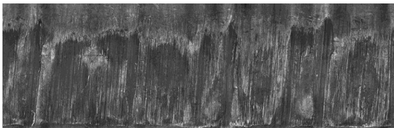
Рис. 4. Фотооптическая развертка поверхности пули, выстреленной из переделанного под патрон 9x18 пистолета ИЖ-79-9Т. Следы контакта со стволом видны на всей поверхности пули
