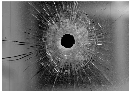
Рис. 6. Пулевое повреждение в стекле. Выстрел из 7,62-мм винтовки Мосина
