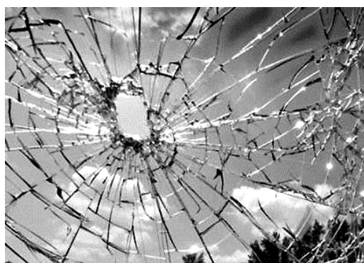
Рис. 4. Разрушение триплекса со сквозным пробиванием при энергии удара порядка 90 Дж
