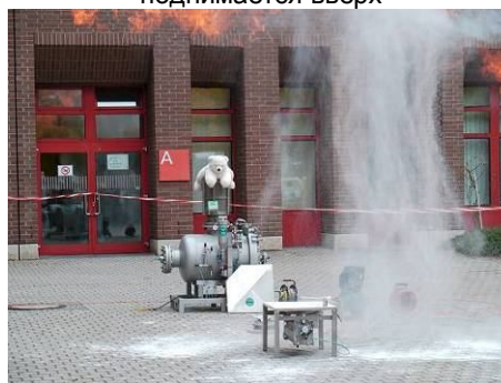
6. Последствия взрыва, на землю осаждается несгоревшая мука
