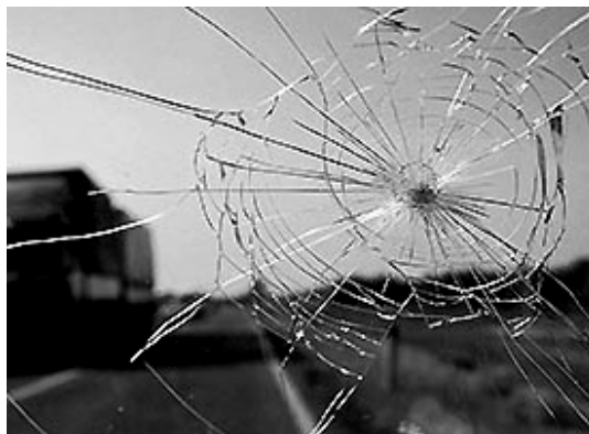
Рис. 1. Сетка радиальных и концентрических трещин на ветровом стекле при ударе камнем в среднюю часть
