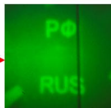
Рис. 15. Скрытое лазерное изображение, визуализированное с использованием «Регула-2305»
