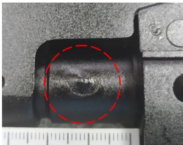
Рис. 5. След от вставленного штифта в патроннике ствола
