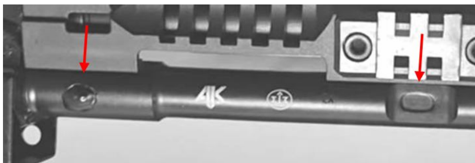
Рис. 2. След от штифта в патроннике ствола (вид слева) и пропил в средней части (вид справа)
