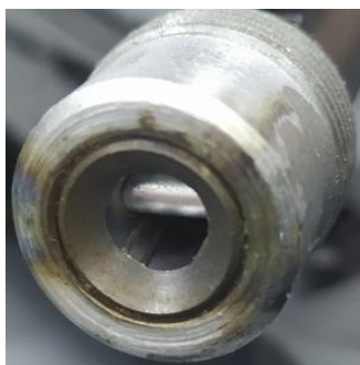
Рис. 4. Расположение штифта у дульного среза ствола (слева), вид шлифовки металла в месте расположения штифта сбоку (справа)
