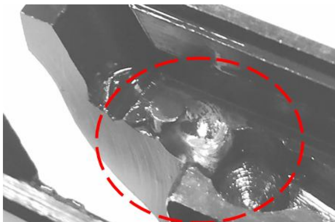
Рис. 10. Вид штифта со следами сварки и ослабления конструкции затвора
