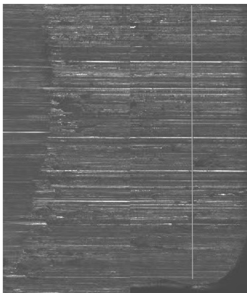
Рис. 4. Результат совмещения следов на экспериментальных снарядах, полученных в результате протяжки при различных условиях: слева – «без остановки», справа – «с остановкой»
