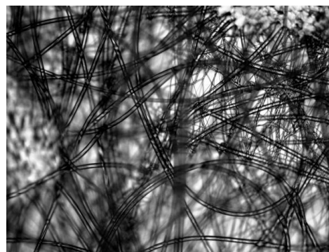
Рис. 20. Структура нетканого материала среднего слоя маски «Чистовье»
