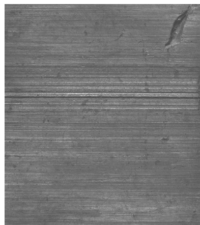
Рис. 6. Увеличенное изображение следов на экспериментальном снаряде, протянутом через канал правого ствола обреза двуствольного охотничьего ружья ТОЗ-БМ (16 калибра)
