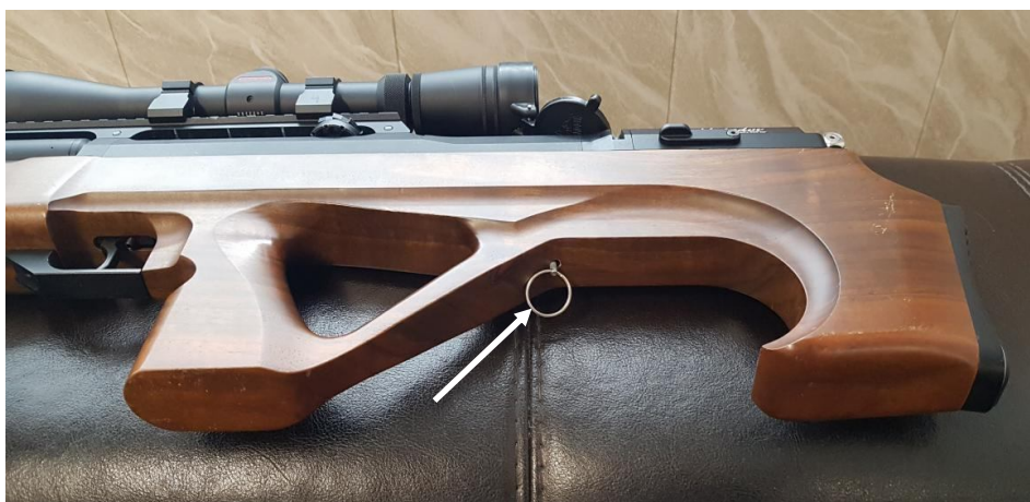
Рис. 5. Внешняя часть устройства для оперативного уменьшения дульной энергии на винтовке Matador производства EDgun (отмечено стрелкой)
