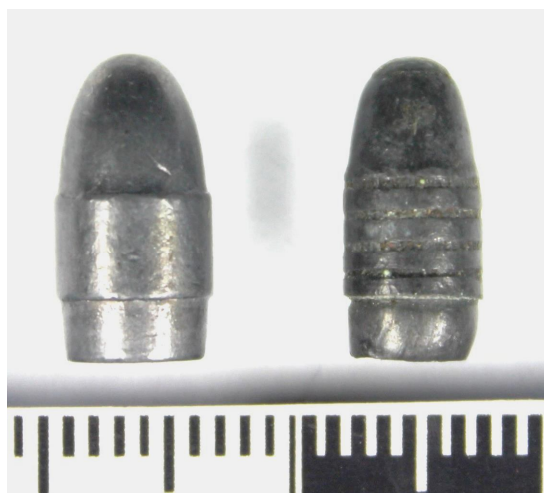
Рис. 7. Пуля для пневматического оружия калибра 6,35 мм (слева) и пуля патрона калибра 5,6 мм (.22LR) (справа)
