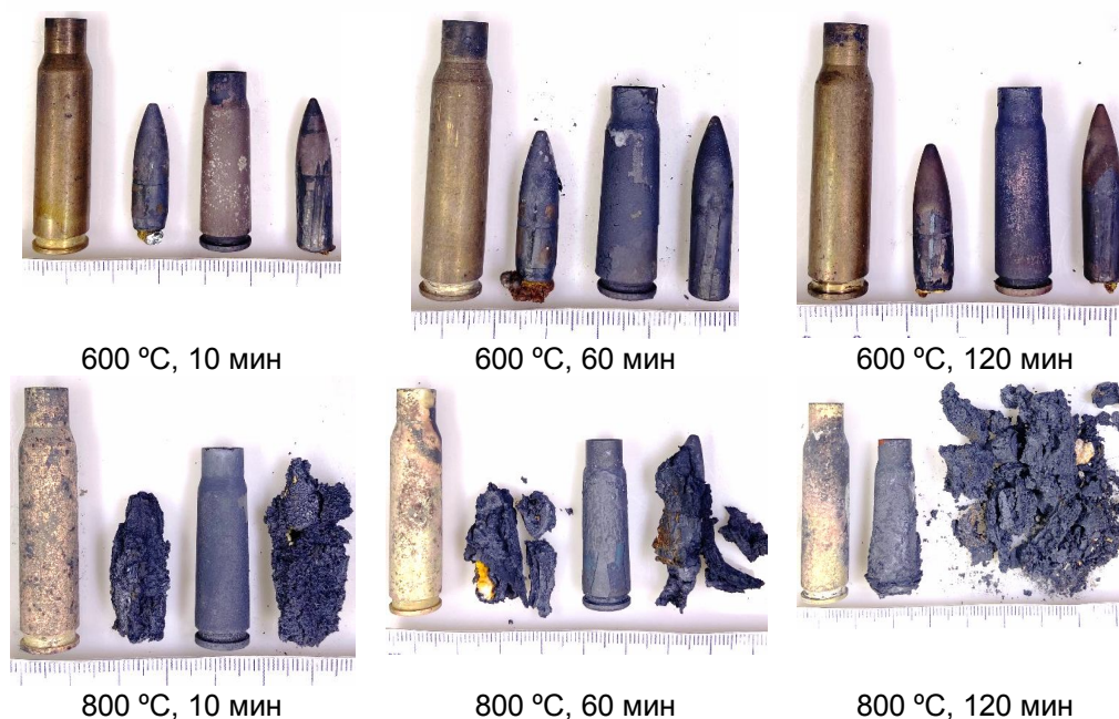
Рис. 5. Внешний вид пуль и гильз после обжига
