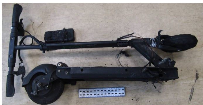
Рис. 6. Общий вид представленного электросамоката и блока питания
