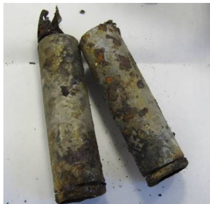
Рис. 9. Внешний вид поврежденных аккумуляторов
