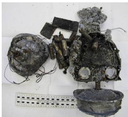
Рис. 8. Общий вид представленных остатков обгоревшего гироскутера
