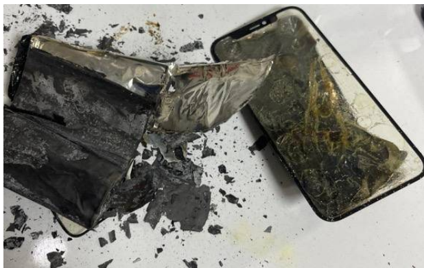
Рис. 4. Мобильный телефон с разрушенной физическим взрывом ЛИАКБ
