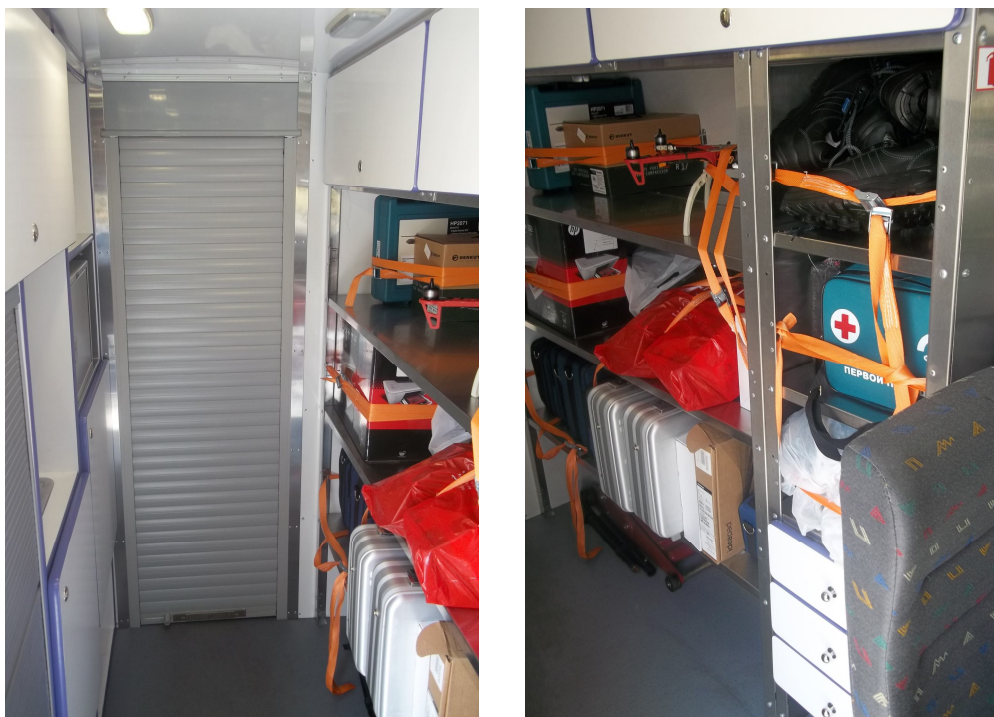
Рис. 4. Лабораторный отсек ППТЛ: слева — вид со стороны кабины водителя; справа — со стороны входа в отсек
