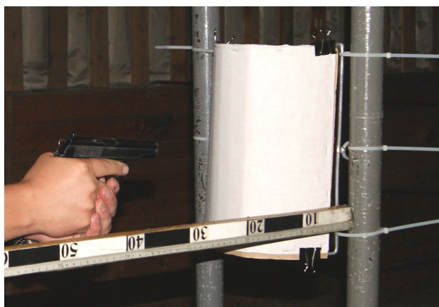
Рис. 4. Съёмный элемент с мишенью, закрепленный вертикально, до выстрела
