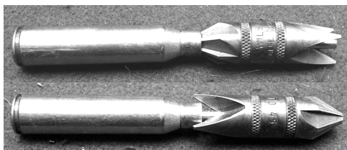
Рис. 11. Снятие заусенцев с дульца гильзы двусторонней фрезой (вверху — с внутренней поверхности дульца гильзы, внизу — с внешней)
