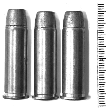
Рис. 15. Разная глубина посадки пуль в гильзы
