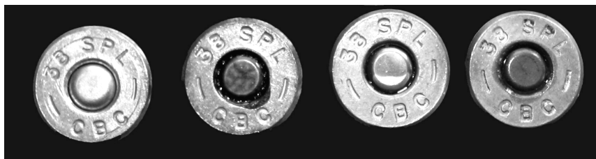
Рис. 13. Неравномерное и разноцветное герметизирующее лаковое покрытие на капсюлях патронов
