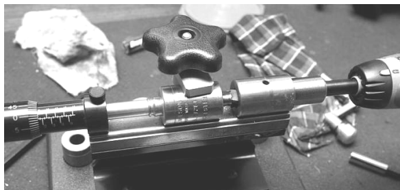
Рис. 4. Триммер с кейсхолдером для удержания обрабатываемой гильзы
