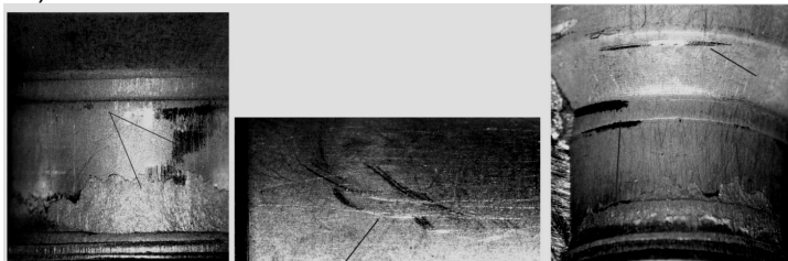
Рис. 3. Увеличенное изображение фрагментов внутренних поверхностей втулки (корпуса) стержневого пломбировочного устройства «С-3-0421» со следами производственных механизмов
