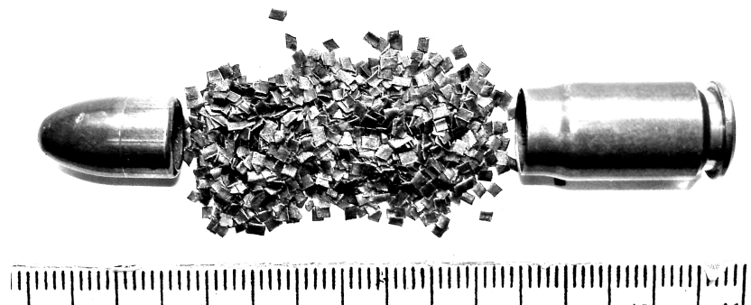
Рис. 14. Использование ружейного пороха «Сокол» для снаряжения пистолетного патрона калибра .357 SIG
