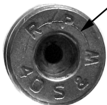
Рис. 8. Конструкция запального отверстия. Стрелкой показан кольцевой след от патрона электроинструмента
