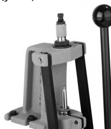
Рис. 6. Пресс с нексайз-матрицей (вверху) и шелхолдером с гильзой (внизу)
