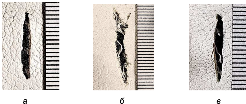
а б в Рис. 14. Повреждения на кожаменителе, образованные клинками с П-образной (а), Т-образной (б) и дугообразной (в) формами поперечного сечения обуха
