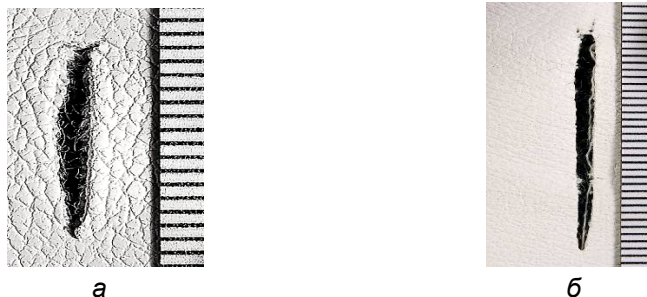
Рис. 11. Повреждения на кожаменителе, в которых невозможно дифференцировать форму клинка: а – прямая; б – изогнутая
