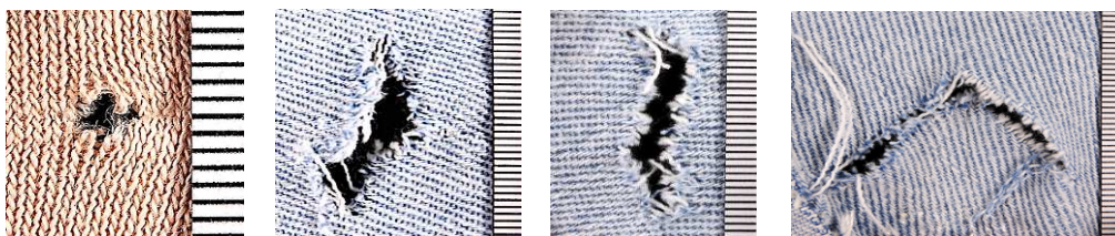
Рис. 24. Различная форма повреждений, образованных клинками ножей с большим углом схождения острия
