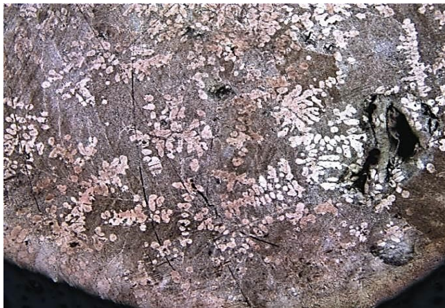
Рис. 8. Дендритная микроструктура электрического проводника при увеличении 100х
