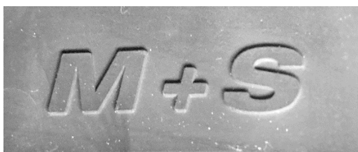
Рис. 3. Обозначение Mud + Snow («грязь + снег»), указывающее на возможность эксплуатации шины в условиях грязи и снега
