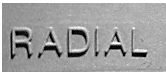
Рис. 2. Указание конструкции шины
