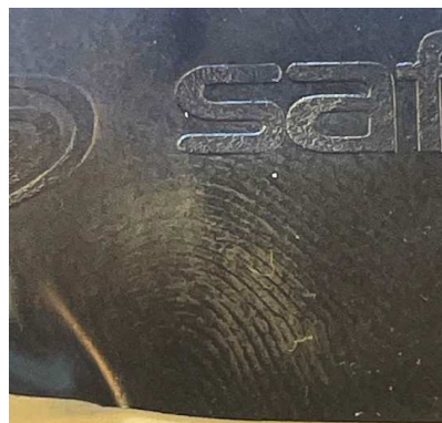
Рис. 4. След пальца руки, выявленный на нелипкой поверхности электроизоляционной ленты ПВХ черного цвета
