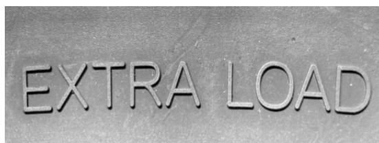
Рис. 6. Обозначение усиленной шины
