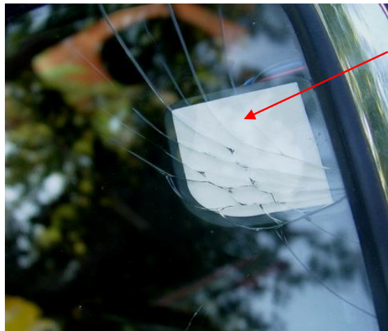
Рис. 3. Механическое повреждение, возникшее при кустарной установке стекла
