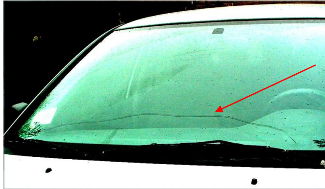
Рис. 2. Волнообразная трещина огибает дефлектор обогревателя
