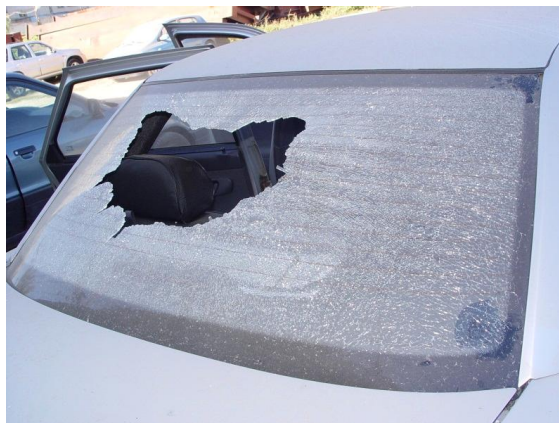
Рис. 6. Повреждение закаленного стекла от ударного механического воздействия
