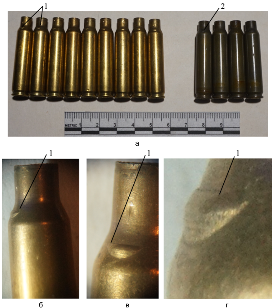
Рис. 5. Образование следа маркера на скате гильзы 5,56 x 45, стрелянной из автомата АК-101. Линиями обозначены: 1 – след маркера в виде выступающего полумесяца на скате латунной гильзы; 2 – след маркера на стальной лакированной гильзе
